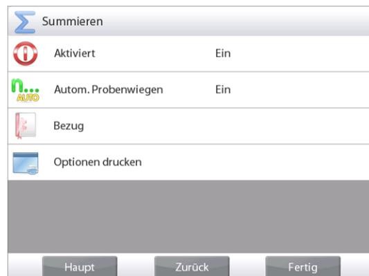
Die Schale leeren (wenn notwendig). Eine neue Probe hinzufügen. Das Gewicht des Artikels wird auf der Hauptanzeigezeile eingeblendet.
