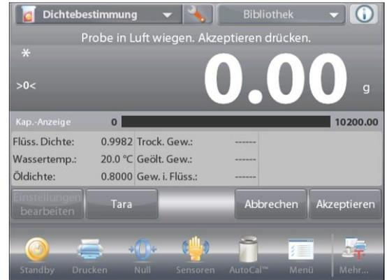
**Schritt 2 von 3 – Geölte Probe in Luft wiegen**
