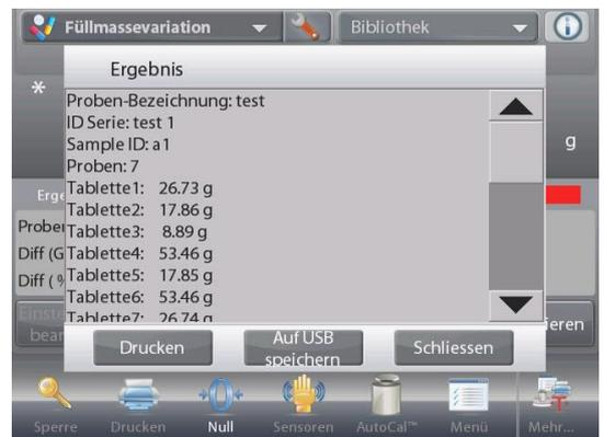
Stecken Sie einen USB-Stick in die Waage, wenn Sie das Ergebnis speichern möchten. Sobald das Laufwerk eingelegt ist, sehen Sie eine Schaltfläche **Save to USB (Auf USB speichern)**. Tippen Sie auf die Schaltfläche, um das Ergebnis zu speichern.
