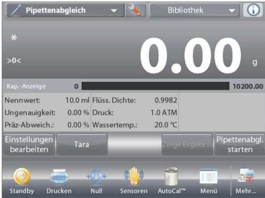
Die Schaltfläche **Pipettenabgleich starten** berühren. Die Anweisungen am Bildschirm befolgen: **Behälter auf Schale stellen. Dann Tara drücken.**
