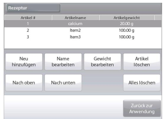
Auf **Start Rezeptur** drücken. Die Anweisungen auf dem Bildschirm befolgen. Die jeweils erforderliche Komponente der Rezeptur hinzufügen. Das Komponentengewicht wird auf der Hauptanzeigeeile eingeblendet.
