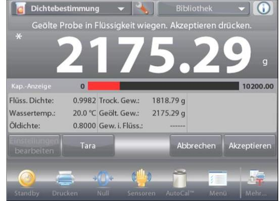
Nachdem die notwendigen Gewichtswerte bestimmt wurden, wird die Dichte der Probe (zusammen mit dem Gewicht in Luft, dem ungeölte und geölte Gewicht in Wasser) in **g/cm3** auf dem Anwendungsbildschirm angezeigt.
