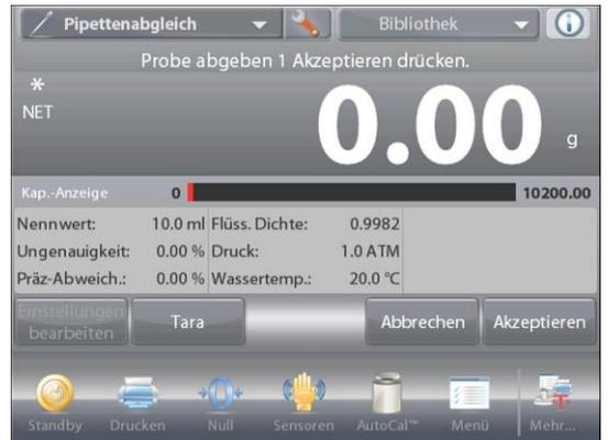
Weiter die Bildschirmanweisungen befolgen, indem Sie Proben abgeben und auf **Akzeptieren** drücken, um jedes Probengewicht zu speichern (Flüssigkeit).
