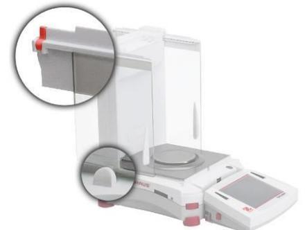
Glastür zum Hineinschieben positionieren. Verriegelungslasche (oben) öffnen; in die obere Rille einsetzen und in die untere Rille schieben. Verriegelungslasche schließen.
