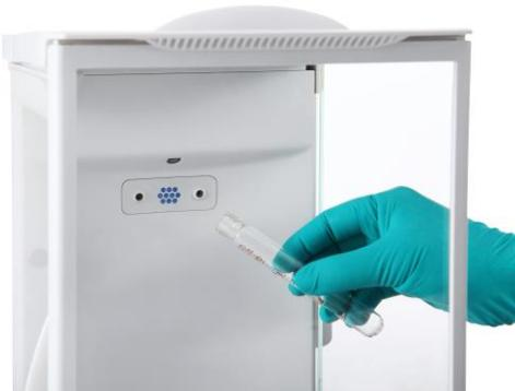
Der Ionisator erzeugt ständig bipolare Ionen durch Gleichstrom-Koronaentladung von positiven und negativen Entladungselektroden und leitet die ionisierte Luft auf den aufgeladenen Körper, um die statische Aufladung zu beseitigen. Die Polarität der erzeugten Ionen ist ausgeglichen, und die statische Aufladung kann unabhängig von der Polarität des aufgeladenen Körpers eliminiert werden.
