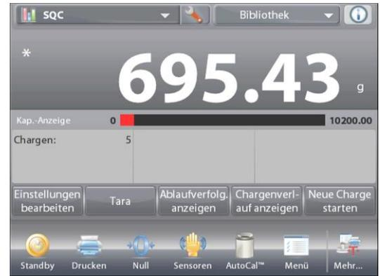
Auf dem Bildschirm „Chargenverlauf anzeigen“ werden die Grundinformationen eingeblendet – **Maximum, Minimum, Durchschnitt** (Mittelwert) und **Standardabweichung** – für alle derzeit gespeicherten Chargen.
