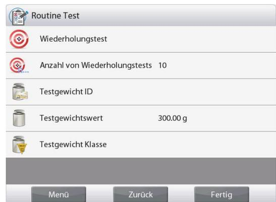
Wenn der Wiederholbarkeitstest abgeschlossen ist, werden die Ergebnisse automatisch angezeigt. Tippen Sie auf **Print (Drucken)**, um den Prüfbericht über die Wiederholbarkeit zu drucken. Tippen Sie **Min-weight (Minimalgewicht)**, um das Referenz-Minimalgewicht anzuzeigen. Nach Verlassen des Routinetests werden die Ergebnisse automatisch gelöscht
