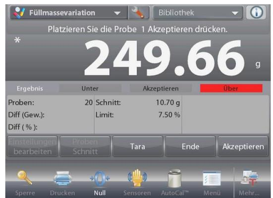
Folgen Sie anschließend den Anweisungen auf dem Bildschirm, um die Probe 2 auf die Waagschale zu legen, und berühren Sie die Schaltfläche **Accept (Annehmen)**, um fortzufahren.
