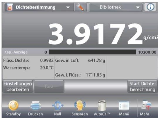
**Schritt 1 von 2 – Probe in Luft wiegen**
