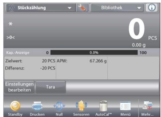
Das standardmäßige (oder letzte) durchschnittliche Stückgewicht (APW) wird angezeigt. Objekte auf die Schale platzieren, um den Füllstatus anzuzeigen.
