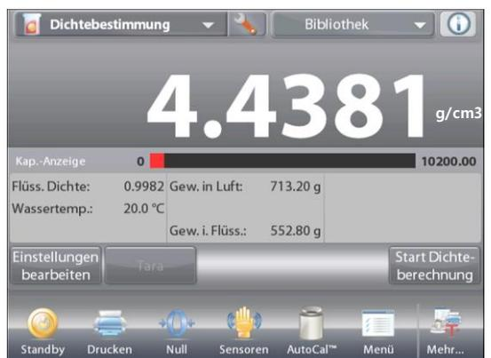
Nachdem die notwendigen Gewichtswerte bestimmt wurden, wird die Dichte der Probe (zusammen mit dem Gewicht in Luft und dem Gewicht in Wasser) in **g/cm³** auf dem Anwendungsbildschirm angezeigt.
