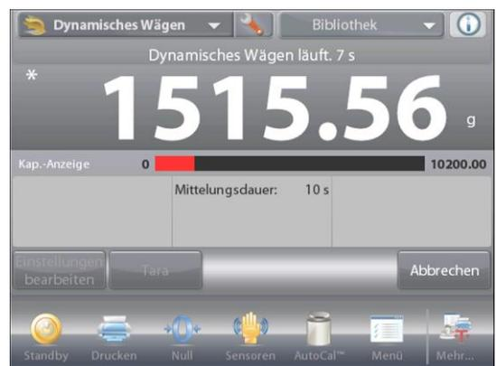
Nach Beendigung des Zyklus entnehmen Sie die Probe und die Waage kehrt automatisch zum Startbildschirm zurück.
