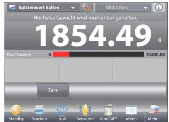
Der höchste stabile Gewichtswert wird gehalten, bis das Gewicht entfernt wird.
